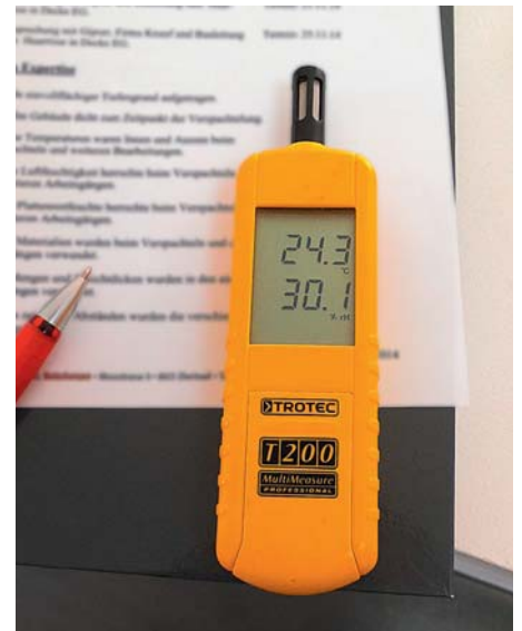
Bild 11: Messung der Luftfeuchtigkeit während des Augenscheins.
